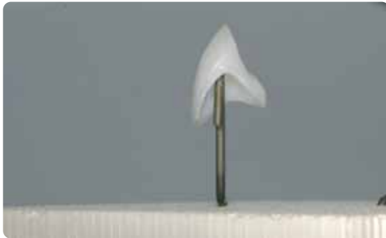
Реставрацию поместить на трегер с сотовой структурой и обжечь.
