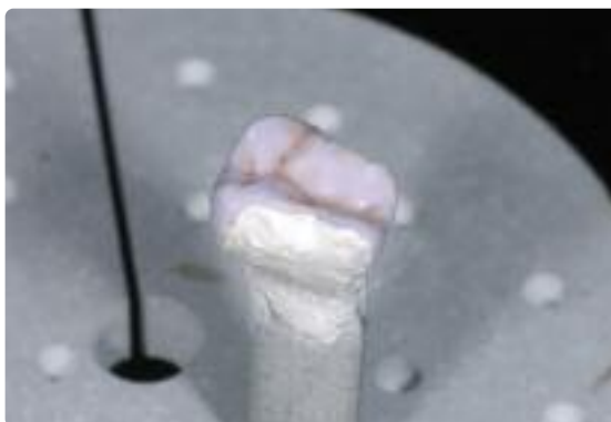
Поместить реставрацию на лотке IPS e.max CAD Crystallization Tray в печь и провести обжиг с заданными параметрами.
