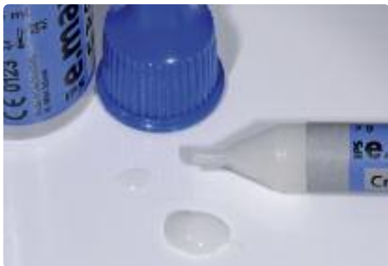
Выдавите глазурь-пасту IPS e.max CAD Crystall./Glaze из шприца и перемешайте. При необходимости слегка разбавьте жидкостью для глазури IPS e.max CAD Crystall./Glaze Liquid
