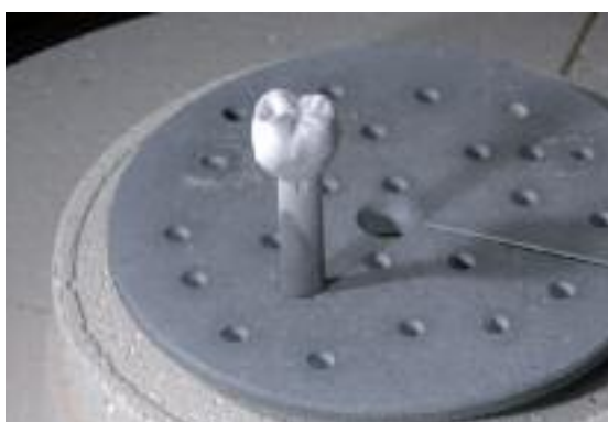
Установите реставрацию на лотке IPS e.max CAD Crystallization Tray в печь и проведите обжиг с заданными параметрами.
