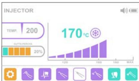
В режиме нагрева и охлаждения гуттаперчи на экране «Estus Multi» отображается шкала текущей температуры. При нагреве шкала температуры закрашивается **ОРАНЖЕВЫМ** цветом, при охлаждении - **СИРЕНЕВЫМ**
