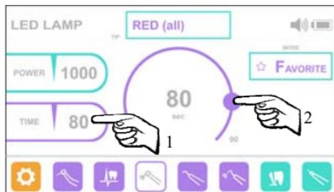
кнопку «TIMER» (ВРЕМЯ) и с помощью кругового регулятора установите требуемое значение времени в пределах от 5 до 20 сек с шагом 5 сек. для насадок типа «BLUE» или в пределах от 30 до 90 сек. с шагом 10 сек. для насадок типа «RED».
