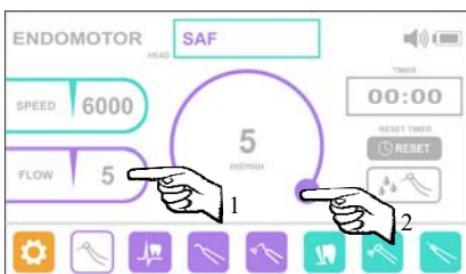
«**FLOW**» (СКОРОСТЬ ПОТОКА) и с помощью кругового регулятора установите требуемое значение скорости в пределах от 1 до 5 мл/мин с шагом 1 мл/мин
