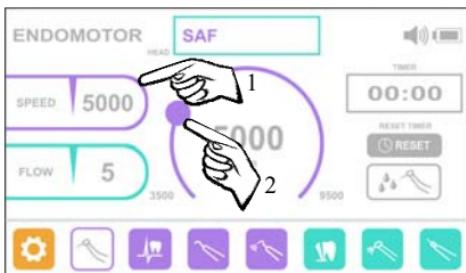
«**SPEED**» (СКОРОСТЬ) и с помощью кругового регулятора установите требуемое значение скорости в пределах от 3500 до 9500 об/мин с шагом 500 об/мин
