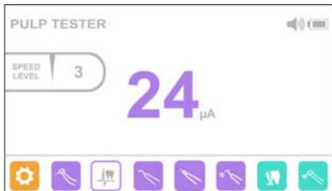
В процессе проведения диагностики на экране «Estus Multi» отображается текущее значение диагностического тока от 01 до 80 мкА
