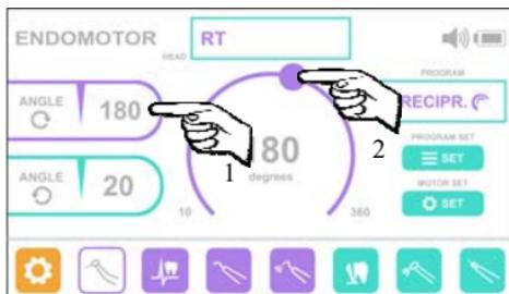
и с помощью кругового регулятора установите требуемое значение угла в пределах от 10 до 360° (с шагом 10°)
