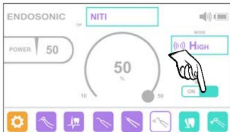
эндоскалера H-SCAN, H, M, L при его автономной работе (*подробнее см. Руководство по эксплуатации для эндодонтического ультразвукового скалера «Estus Sonic»*). Изменение рабочих параметров в данных режимах НЕВОЗМОЖНО.
