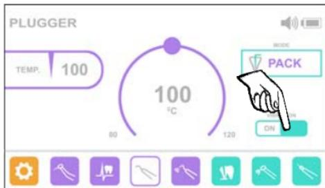
основном режиме «PACK» переведите переключатель VIBRATION (ВИБРАЦИЯ) в положение «ON», для возврата к режиму «PACK» (без вибрации) - в положение «OFF»
