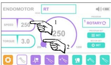
Для изменения текущего значения скорости нажмите на кнопку «**SPEED**» (СКОРОСТЬ) и с помощью кругового регулятора установите требуемое значение
