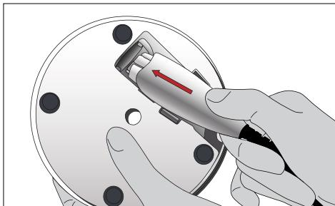
Подсоединить сетевой кабель к сети и блоку питания. Обозначение Power на блоке питания загорится зеленым светом и указатель мощности на зарядном блоке на кратковременно подсветится.
