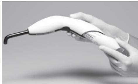
Reposer délicatement la pièce à main sur la base de chargement, à l'emplacement prévu à cet effet, sans forcer. Si vous utilisez une housse de protection, n'oubliez pas de la retirer avant de mettre la batterie en charge. Si possible, toujours utiliser la lampe avec une batterie complètement chargée, afin d'en prolonger la durée de vie. Il est conseillé de remplacer la pièce à main sur la base de chargement après chaque patient. Le temps de charge d'une batterie vide est de 2 heures.
