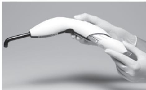
Coloque cuidadosamente a peça de mão no apoio correspondente na base de recarga. Se uma barreira de proteção for usada, remova-a antes de carregar a bateria. Se possível, use a lâmpada sempre com a bateria completamente carregada. Isto prolongará a vida útil. Portanto, é recomendável colocar a peça de mão na base de recarga após cada paciente. Se a bateria estiver completamente descarregada, o tempo de carga é de aproximadamente 2 horas.
