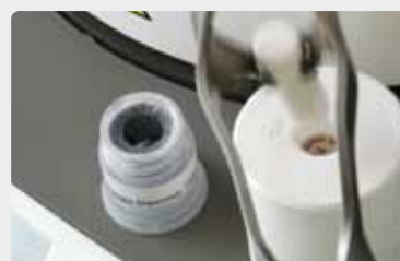
Затем поместить стержень IPS Aloх, покрытый порошком, в горячую опору.
