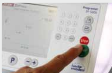
Нажатием клавиши СТАРТ запускается желаемая программа.
