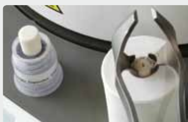
Холодную заготовку IPS InLine PoM желаемого цвета поместить сверху, оказывая давление, на горячую опору.
