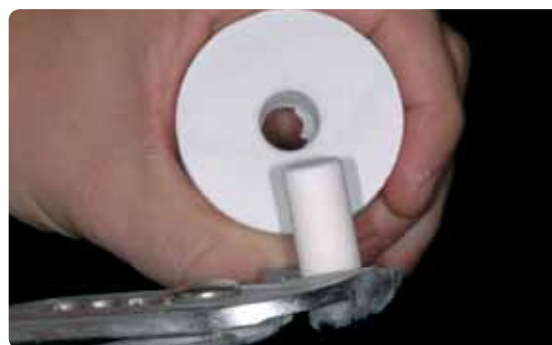
Если стержень извлекается из пакочной массы вращением с помощью щипцов, то он извлекается практически чистым. В любом случае, проверьте, чистый ли он, при необходимости почистите стержень из оксида алюминия частицами Al_2O_3 .
