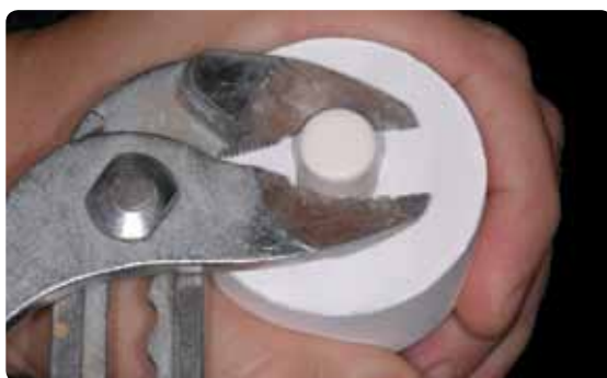
Если стержень извлекается из пакочной массы вращением с помощью щипцов, то он извлекается практически чистым. В любом случае, проверьте, чистый ли он, при необходимости почистите стержень из оксида алюминия частицами Al_2O_3 .
