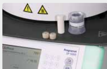
Подготовить холодный стержень из оксида алюминия IPS Aloх и холодную заготовку IPS InLine PoM желаемого цвета.
