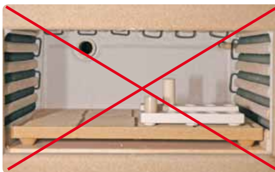
Заготовки IPS InLine PoM и одноразовый стержень IPS 300 г / стержень из оксида алюминия Aloх не прогревать
