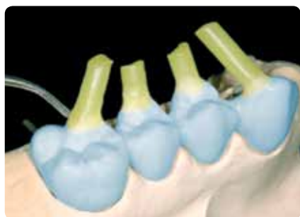
Штифтование всегда проводится на муфельном цоколе IPS в направлении потока керамики и в самой массивной части восковки
