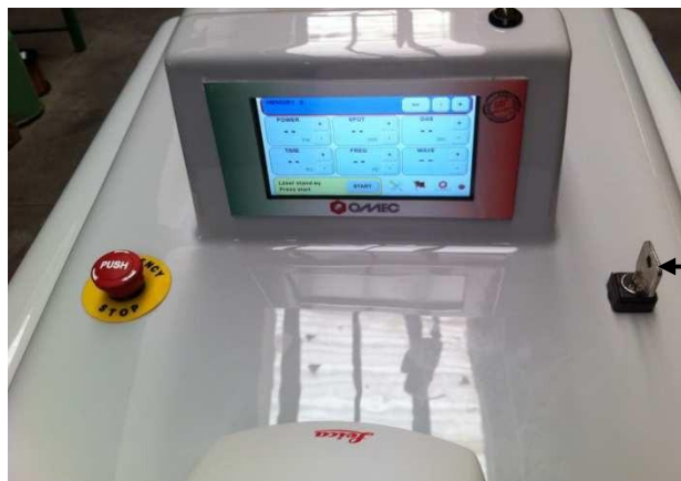
Рисунок 16: Включение при помощи ключа
