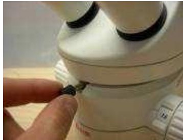
Рисунок 11: Крепление трубки с бинокулярами
