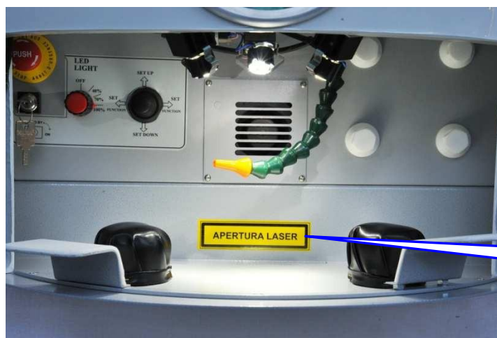
Рисунок 3: Предупреждающие таблички, расположенные внутри аппарата
