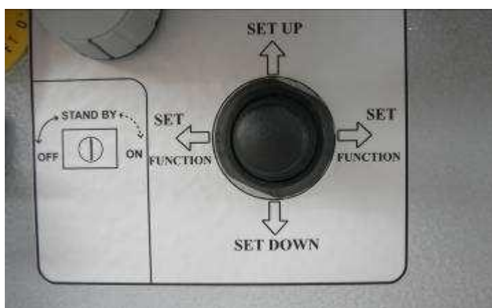
Рисунок 5: Управление при помощи джойстика
