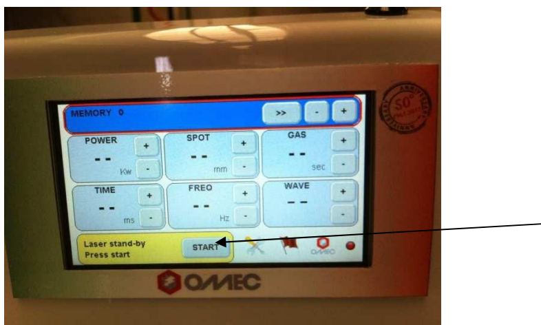
Рисунок 17: Включение при помощи дисплея
