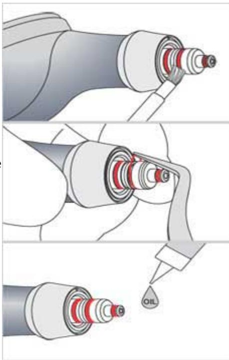
**2** Если порошок налипает в секции уплотняющих колец, снимите уплотняющие кольца и тщательно очистите уплотняющие кольца и пазы.
