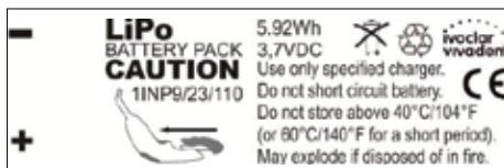
Обратите внимание, что если литий-полимерный аккумулятор используется не в соответствии с назначением и инструкцией или имеет механические повреждения, есть вероятность взрыва, воспламенения или появления дыма. Поврежденные литий-полимерные аккумуляторы использовать нельзя.
